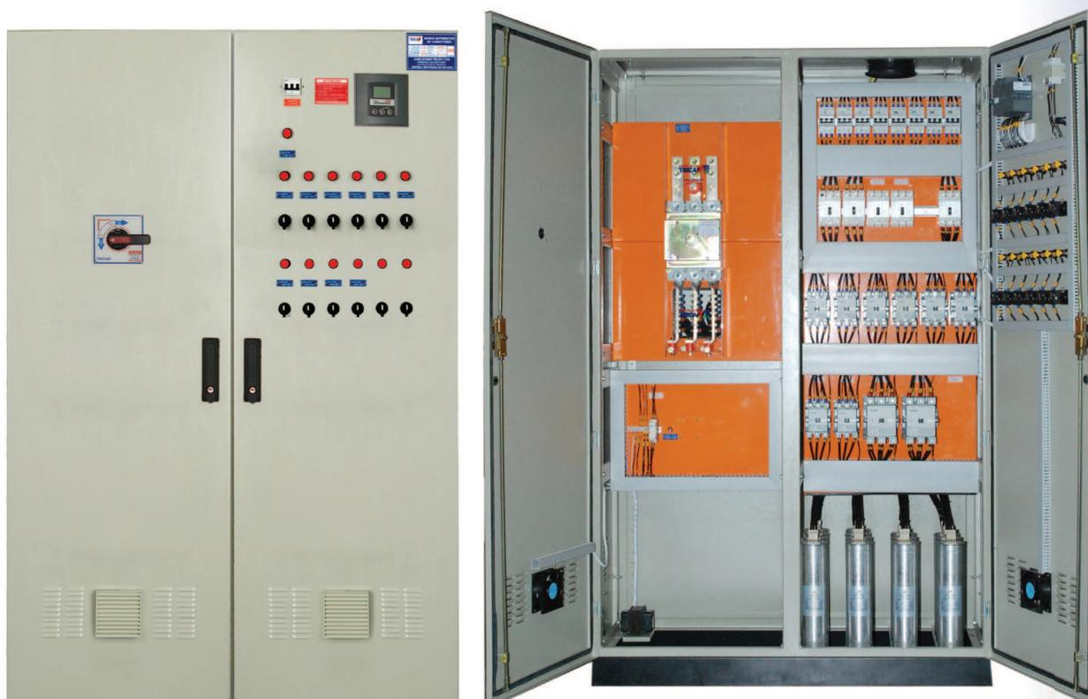
O banco automático de capacitores tricap, é montado com componentes da mais alta qualidade, corrige o fator de potência por estágios, evitando sobretensões e proporcionando maior durabilidade dos equipamentos, pois somente funciona quando há necessidade de reativo indutivo ou capacitivo, mandando-se desta forma o fator de potência dentro dos limites pré estabelecidos, evitando o pagamento de indutivo e capacitivo à concessionária e proporcionando o alívio do sistema de alimentação.
